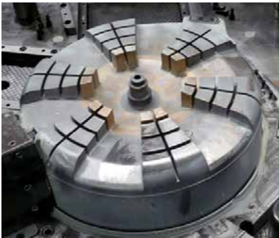
ASSAB 618 T所制成型的洗衣机滚筒核心和铜钹插件。
