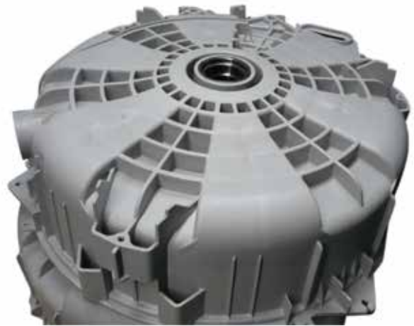
洗衣机的塑料桶—大而复杂形状的塑料桶需要高韧性和高淬透特性的模具钢。
