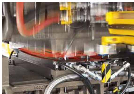
离子或气体氮化可用于热成形模具，以进一步提高抗热磨损的性能，降低模具和被加工料之间的摩擦。照片由AT&T公司提供。
