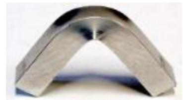
그림 4 언노치드 테스트 결과.
