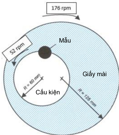
Hình 2 Minh họa phương pháp kiểm nghiệm Pin-on-disc.
