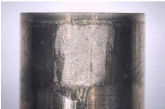
図7.スタンピングパンチで重度の焼き付きが生じた例
