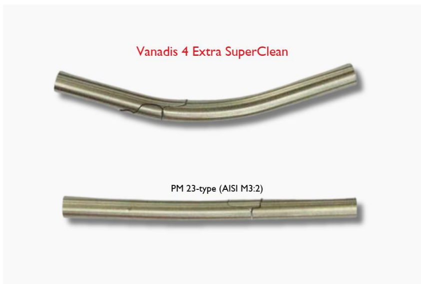
図4. PM23系、60-62 HRC との4点曲げ試験の比較
